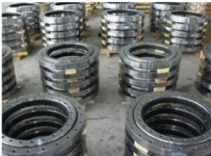
Спецификация поворотный подшипник (поворотное кольцо) для экскаватора
